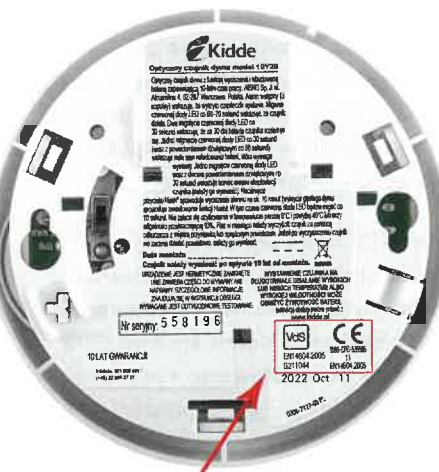
PRZYKŁAD CERTYFIKACJI NA DETEKTORZE CZUJKA DYMU KIDDE MODEL 10Y29
